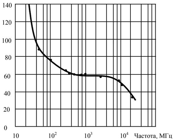
Рис. 1. Дисперсия диэлектрической проницаемости в диапазоне частот [4]
