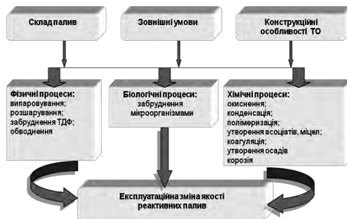
Рис. 1. Чинники та процеси, які впливають на експлуатаційну зміну якості реактивних палив протягом «життєвого циклу»
