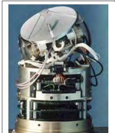
Рис. 2. Головка самонаведення протирадіолокаційної ракети
