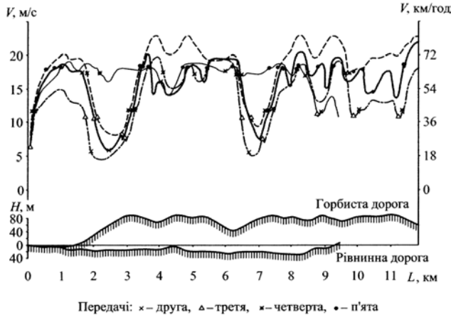
Рис. 1. Графіки зміни швидкості автопоїзда ЗИЛ 130 при різних умовах руху на горбистому і рівнинному маршрутах
