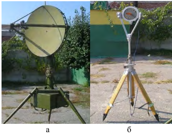
Рис. 6. Исследуемая параболическая (а) и вспомогательная антенны (б)
