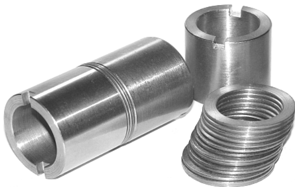
Рис. 2. Елементи пари тертя для проведення експерименту за конструктивною схемою «кільце-кільце»
