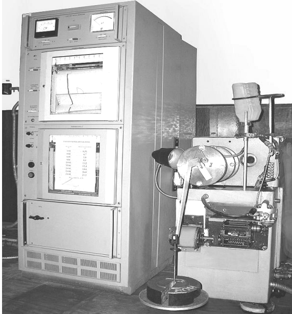
Рис. 1. Вдосконалена стандартна машина тертя 2070 СМТ-1
