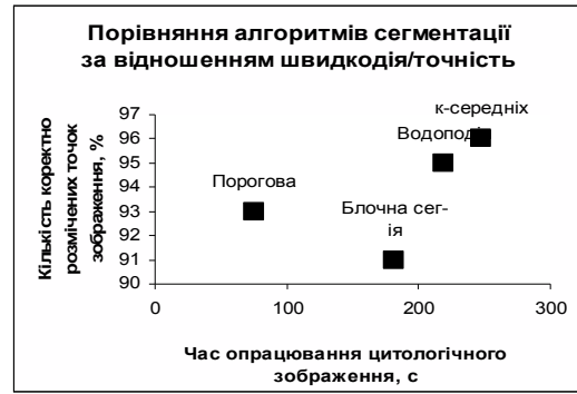
Рис. 8. Порівняння роботи алгоритмів сегментації за критерієм швидкодія/точність
