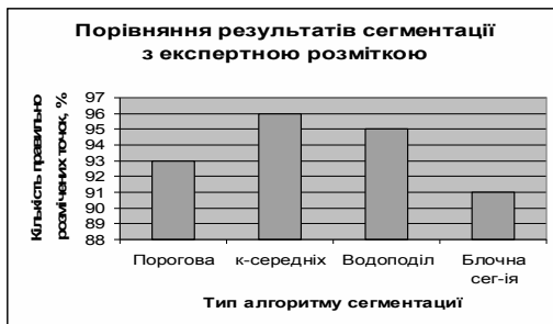
Рис. 7. Порівняння точності роботи алгоритмів сегментації
