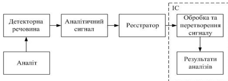
Рис. 1. Функціональна схема вимірювань за допомогою фізико-хімічного сенсора
