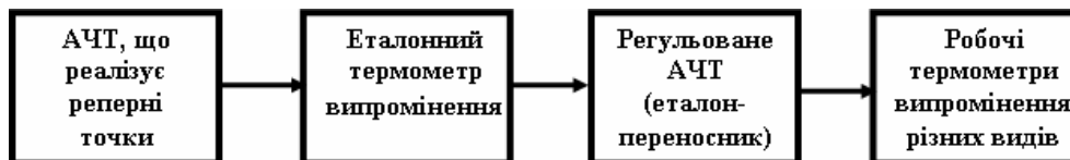
Рис. 1. Загальна схема передачі температурної шкали термометрам випромінювання на основі фундаментального закону Планка з використанням регульованого АЧТ, як еталона-переносника
