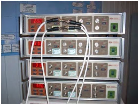
Рис. 2. Зовнішній вигляд групової двономінальної міри із чотирьох мір Andeen-Hagerling типу АН11А
