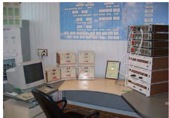
Рис. 1. Зовнішній вигляд Державного еталона одиниць електричної ємності та фактора втрат ДЕТУ 08-06-01
