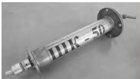
Рис. 6. Шунт вимірювальний коаксіальний ШК-50 для вимірювання імпульсів вихідних струмів генераторів Г-МІЗ
