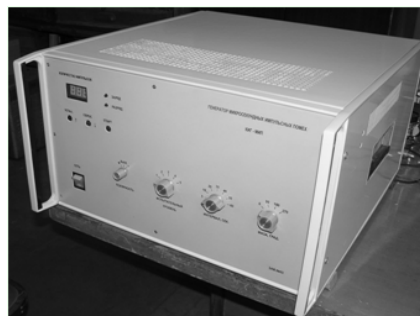
Рис. 3. Загальний вид комбінованого генератора мікросекундних імпульсних завод Г-МИП-6
