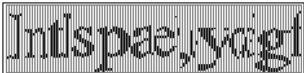
Рис. 12. Фрагмент словаря вертикальных элементов строки, полученный с помощью автоматической классификации
