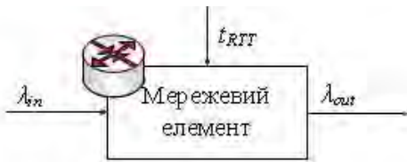
Рис. 2. Схема моделі процесу моніторингу мережевого елемента на мережевому рівні
