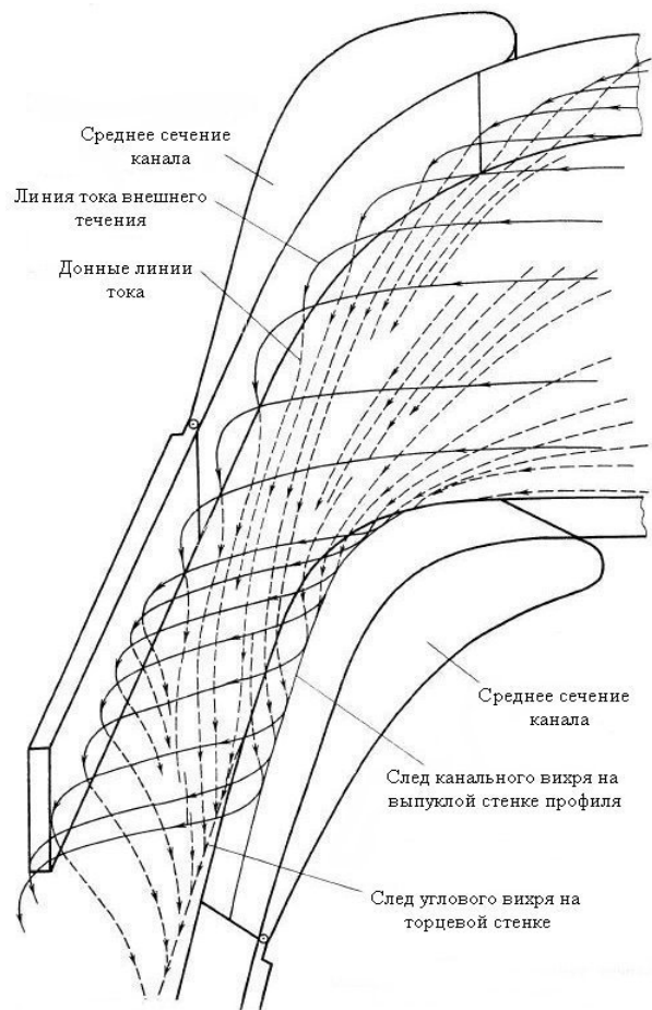
Рис. 4. Линии тока в плоском канале профилей.
