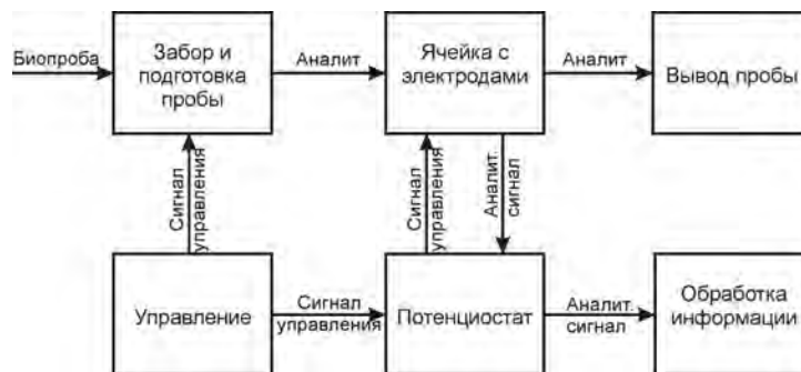
Рис. 1. Структурная схема электрохимической системы экспресс анализа биопроб
