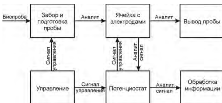
Рис. 1. Структурная схема электрохимической системы экспресс анализа биопроб
