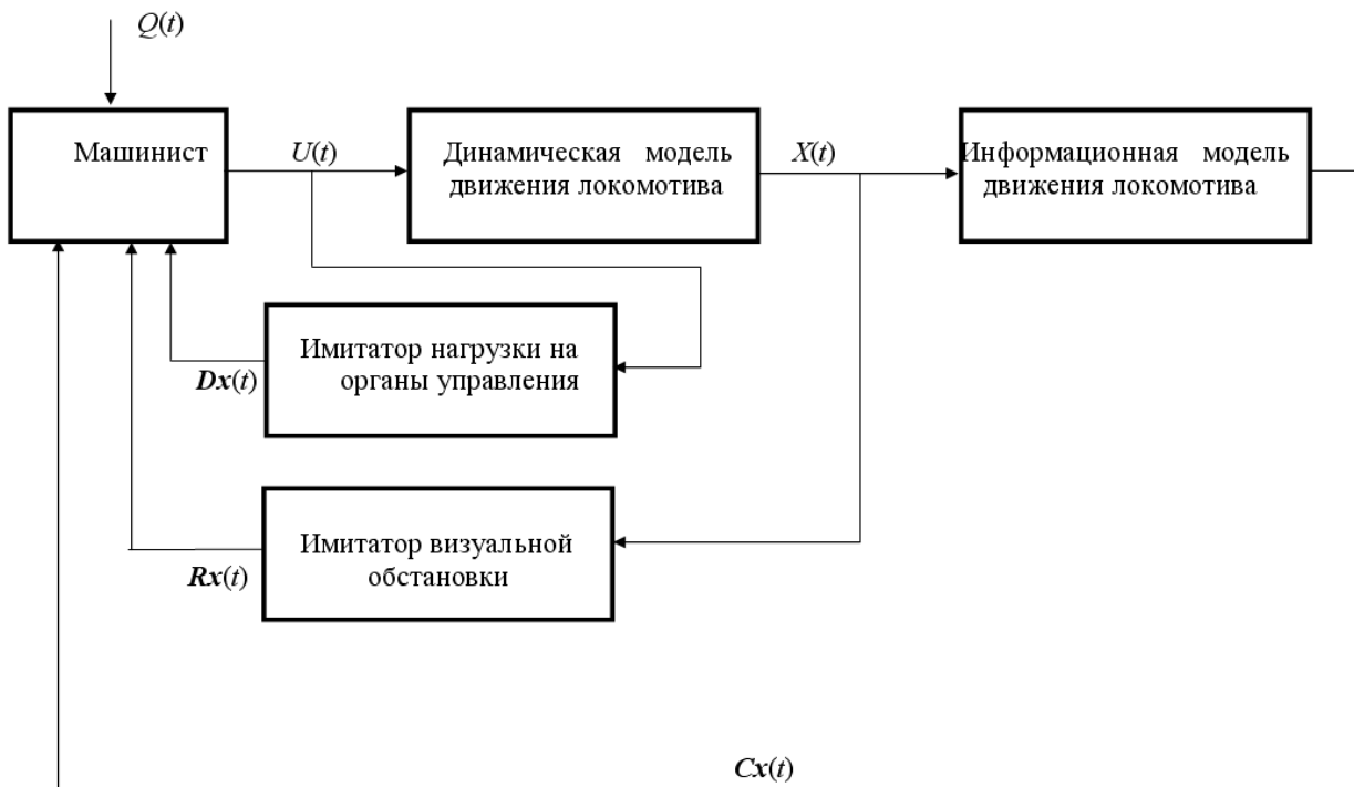
Рис. 2. Структурная схема включения имитатора визуальной обстановки
