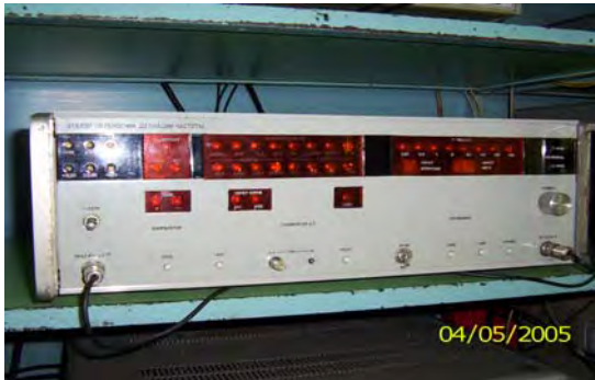
Рис. 5. Зовнішній вигляд ЕП одиниці дев'яти частоти
