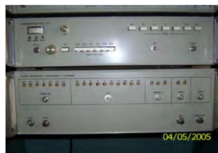
Рис. 3. Зовнішній вигляд ЕП одиниці коефіцієнта гармонік
