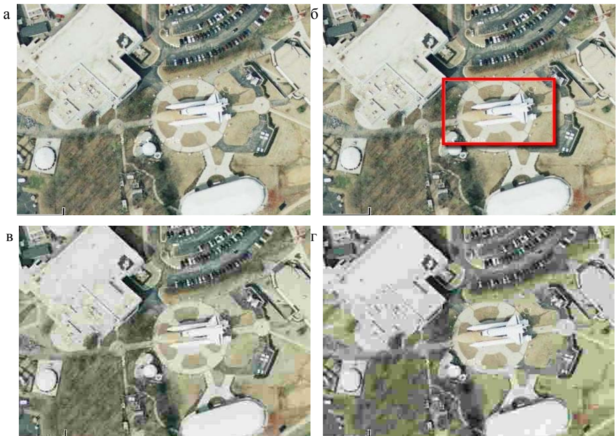
Рис. 1. Приклад зображення, одержаного в результаті моніторингу земної поверхні: а – початкове зображення; б – початкове зображення після виділення зображень об'єктів; в, г – стислі зображення при однаковому значенні СКВ стандартом JPEG і пропонуваними алгоритмами на основі ООП відповідно
