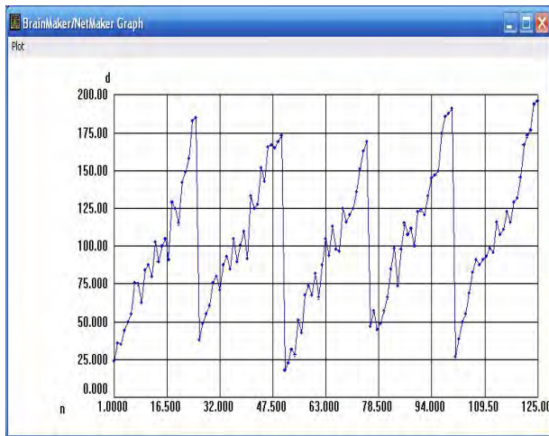
Рис. 1. Точечная диаграмма (временной ряд) отклонений диаметра вала, построенная в модуле NetMaker системы моделирования нейронных сетей BrainMaker Professional
