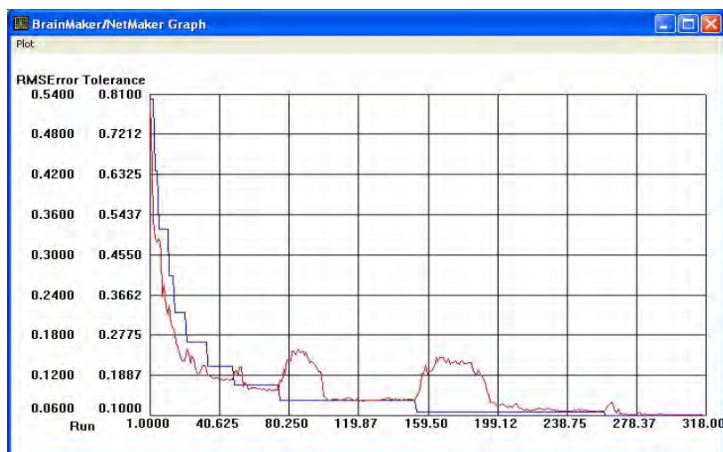
Рис. 5. Графики сходимости модели нейросети по параметрам \text{RMSError} и \text{Tolerance}
