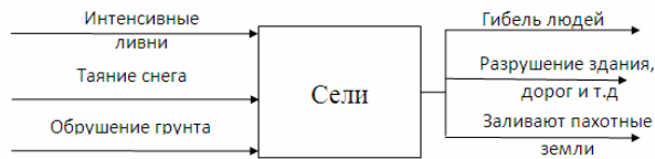
Рис. 5. Структурная схема факторов возникновения и последствий селей
