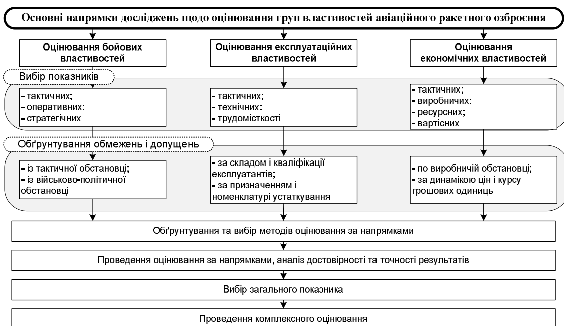
Рис. 2. Схема оцінювання властивостей зразка авіаційного ракетного озброєння при формуванні його технічного обрису
