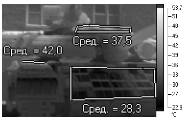
Рис. 2. Оптичне та термографічне зображення танка спереду в частині, що знаходилась під тінню
