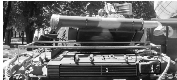
Рис. 5. Розподіл підвищеної температури елементів танка за ділянками під час дослідження: 1 – 90 \pm 5 °С, 2 – 120 \pm 10 °С, 3 – 60 \pm 5 °С.
