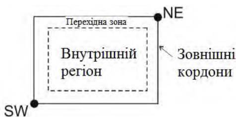
Рис. 2. Завдання регіону для призначення параметрів АІС береговою станцією
