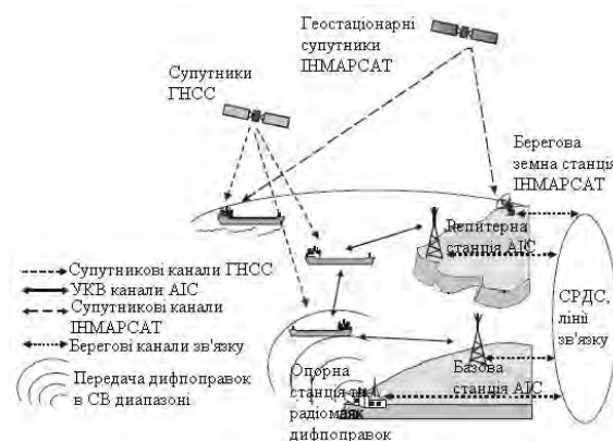
Рис. 1. Спільний принцип функціонування АІС
