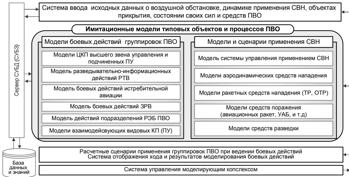
Рис. 1. Обобщенная схема автоматизированной обучающей информационно-моделирующей системы ПВО (возможный вариант построения)
