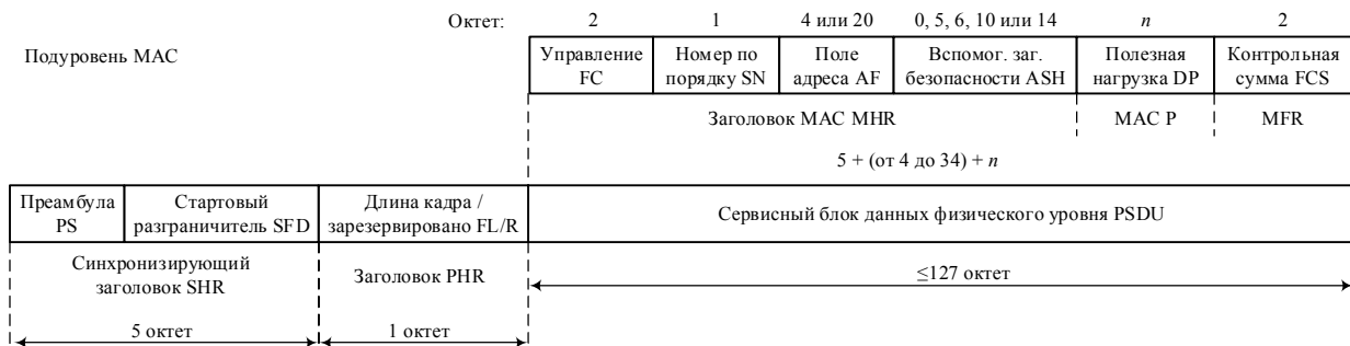
Рис. 2. Схематическое изображение кадра данных
