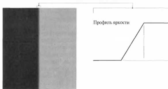
Рис. 1. Две области цветности на снимке и профиль граничного перепада яркости между ними после оцифровки [2]
