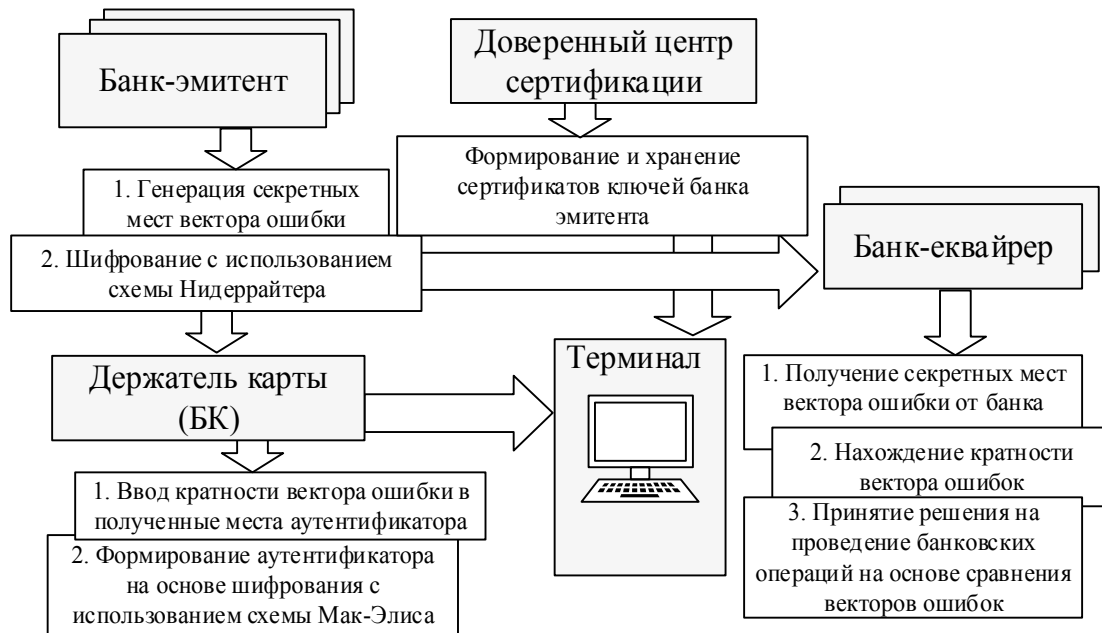
Рис. 4. Структура предлагаемого метода двухфакторной аутентификации на основе крипто-кодированных схем Мак-Элиса и Нидеррайтера
