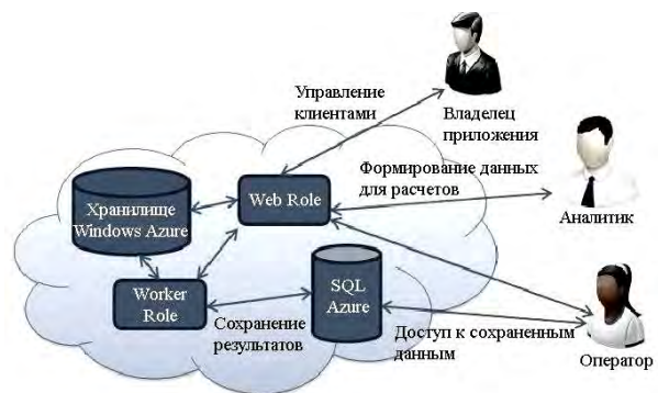
Рис. 1. Архитектура приложения для оптимизации организационной структуры агрохолдинга
