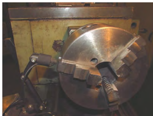
Рис. 5. Экспериментальный стенд для измерения погрешности датчика Холла: 1 – кулачки; 2 – токарный патрон; 3 – датчик Холла
