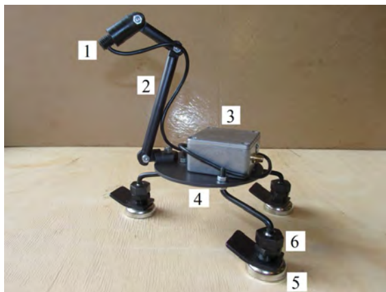
Рис. 2. Общий вид контактного датчика на основе Эффекта Холла: 1 – датчик Холла с магнитом; 2 – составная штанга; 3 – усилитель; 4 – тренога; 5 – крепежные магниты; 6 – шарнирная цапфа
