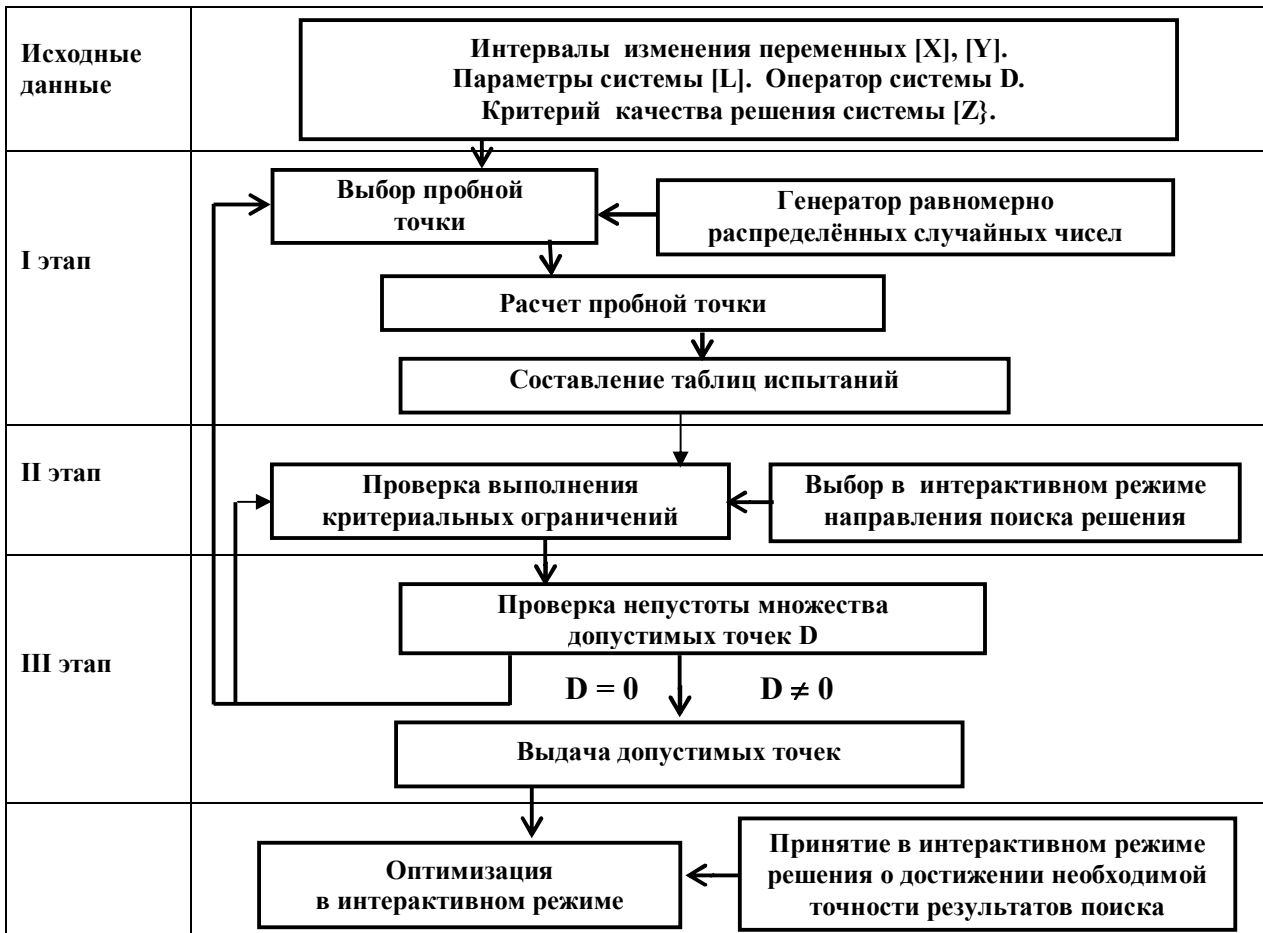
Рис. 4. Укрупнённая блок-схема применения метода исследования пространства параметров
