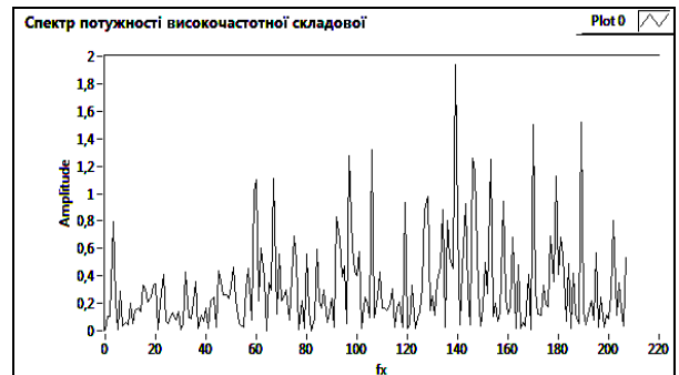
Рис. 6. Графік спектру потужності високочастотної складової зміни яскравостей пікселів уздовж профілю для зображення природної води
