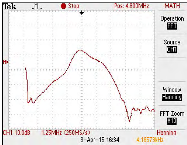
Рис. 5. АЧХ перетворювача П211-5-П20
