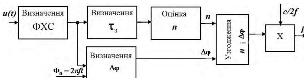
Рис. 1. Структурно-логічна схема двошкального методу ультразвукової лунаїмпульсної товщинометрії
