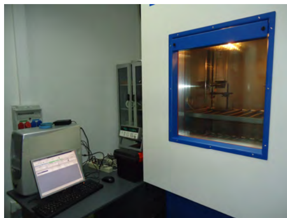
Рис. 5. Подключение датчиков температуры из климатической камеры KPK 400 к системе сбора данных Agilent 34970A
