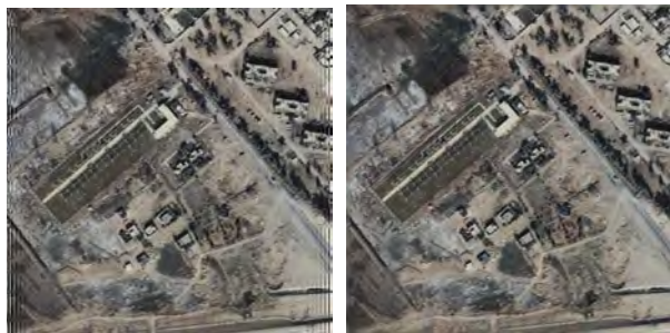
Рис. 2. Оптико-електронні зображення (Фаллуджа, Ірак): а) відновлене зображення з використанням класичного ітеративного методу Ландвебера (вираз (8)); б) відновлене зображення з використанням удосконаленого ітеративного методу Ландвебера (вираз (13))
