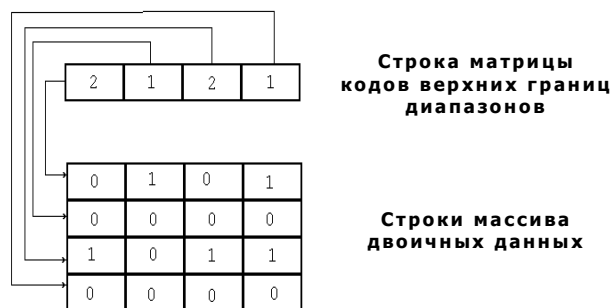
Рис. 4. Схема предложенного процесса восстановления двоичных массивов
