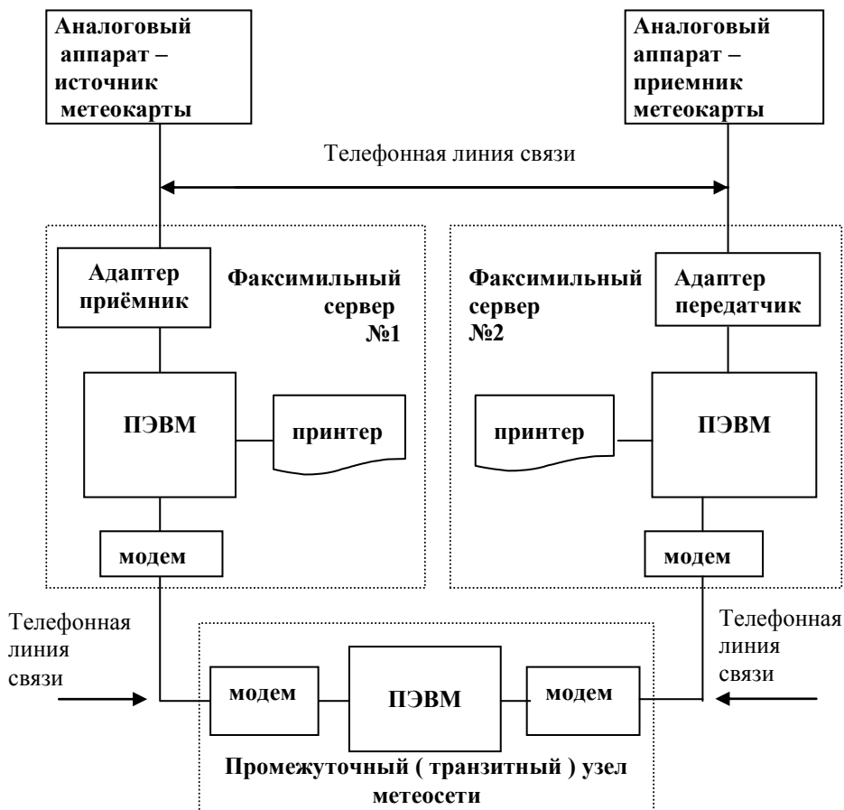
Рис. 1. Схема сети передачи метеоданных при помощи ФС
