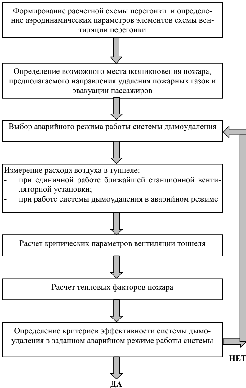
Рис. 1. Алгоритм оценки эффективности системы дымоудаления, обеспечивающий эвакуацию пассажиров при горении подвижного состава в тоннеле метрополитена
