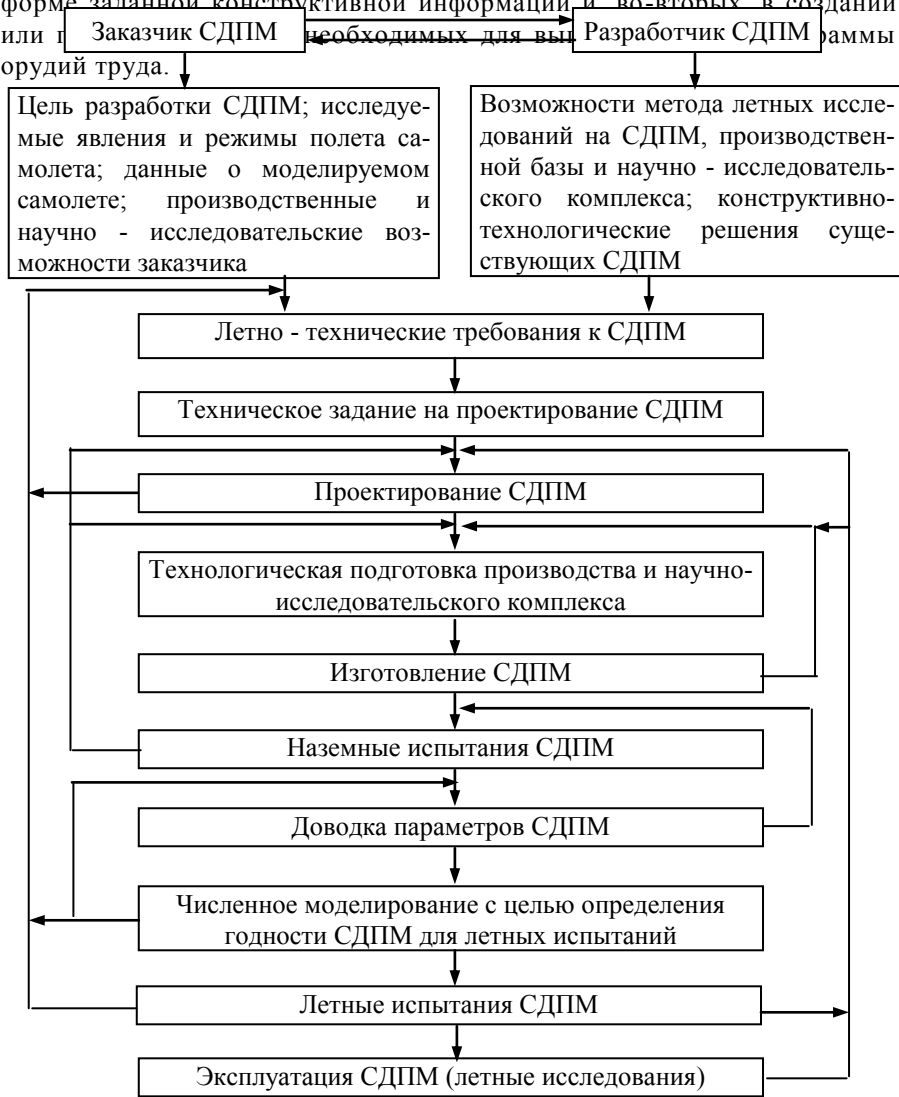
Рис.1. Структура процесса формирования и контроля качества крупномасштабных СДПМ самолетов
