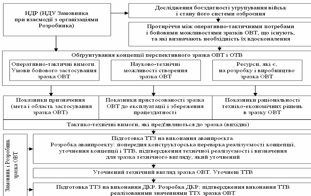
Рис. 7. Послідовність формування і трансформації ОТВ в ТТХ зразка ОВТ (ОТВ → ТТВ → ТТХ)
