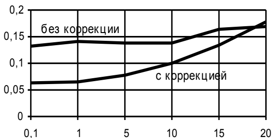
Рис. 4. Графики зависимостей точности определения координаты x от \sigma
