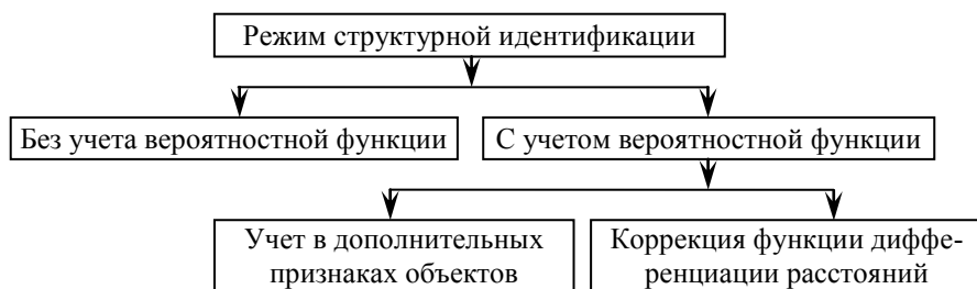
Рис. 3. Схема выбора режима структурной идентификации биомедицинских сигналов
