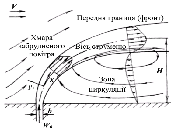
Рис. 1. Схема протікання при вдуванні плоского струменю у поперечний потік, що зносить
