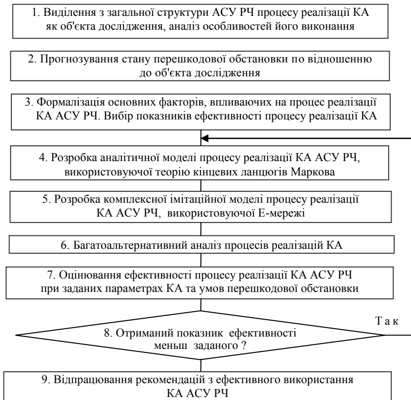
Рис. 1. Алгоритм взаємозалежних етапів методики оцінки ефективності процесу реалізації КА для перспективних АСУ РЧ в умовах впливу електромагнітних і радіочастотних перешкод
