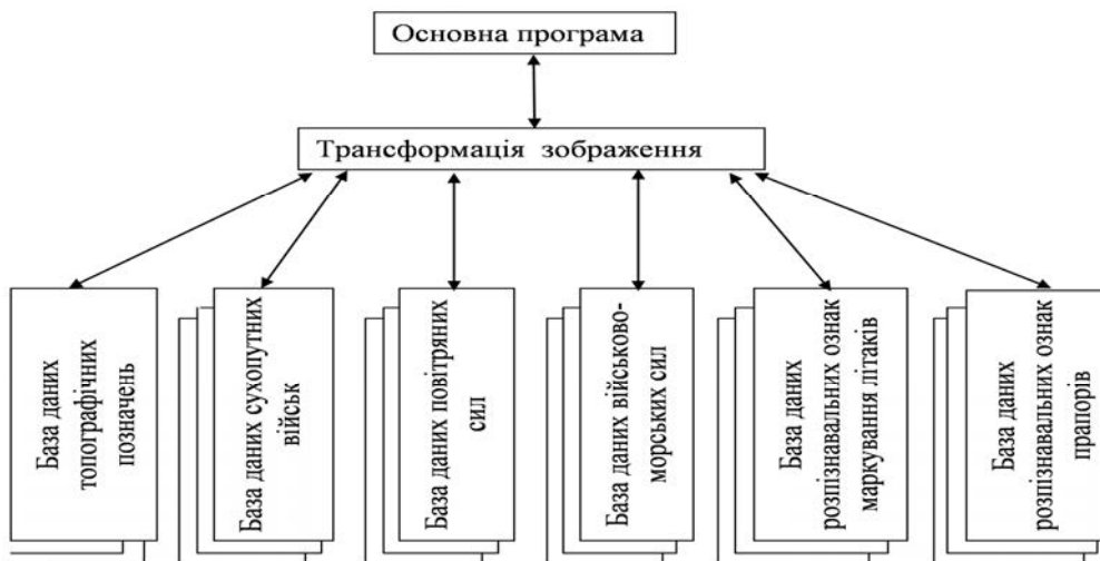
Рис. 2. Функціональна схема тренажеру дешифрувальника програмного вигляду
