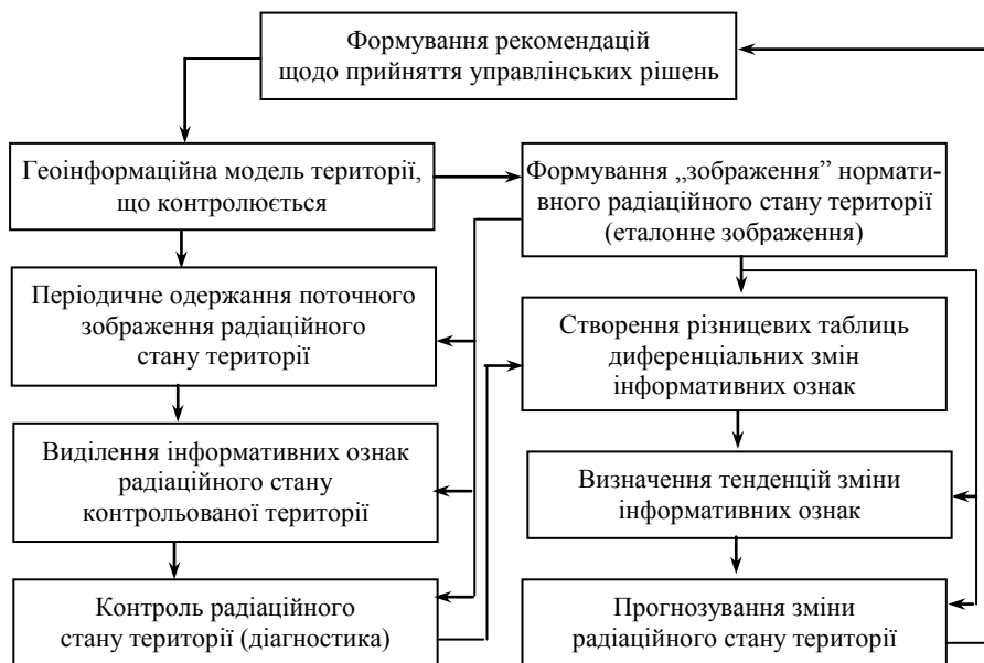
Рис. 3. Схема узагальненої моделі радіаційного моніторингу
