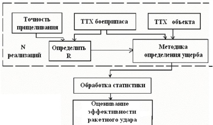
Рис. 2. Схема имитационной модели оценивания ракетного удара
