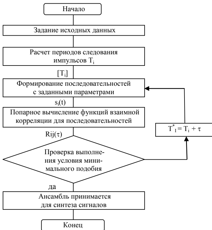
Рис. 1. Структурная схема алгоритма синтеза последовательностей с минимальным энергетическим взаимодействием
