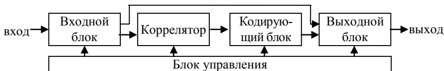
Рис. 1. Структурная схема устройства внутрикадрового кодирования ЦЦТС
