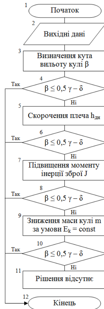
Рис. 6. Методика підвищення оперативності виконання вогневого завдання шляхом узгодження кутів вильоту кулі та поля зору оптичного прицілу
