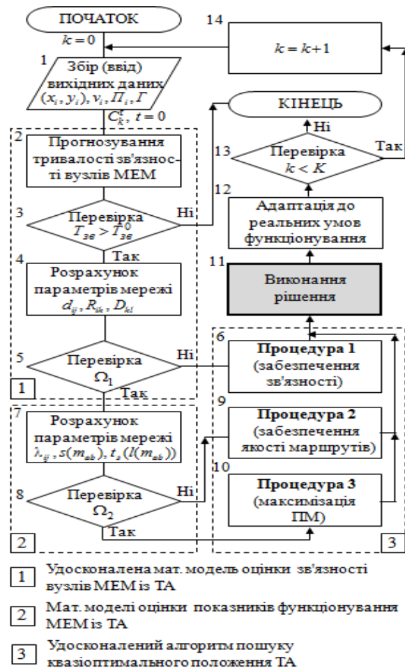
Рис. 2. Схема-алгоритм методу підвищення продуктивності MEM із ТА
